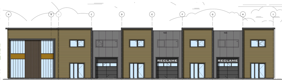
Unit 01 - RECHTERZIJGEVEL - Gebouw 1 - OOSTGEVEL - A doorvalvrij glas volgens NEN 2668 (tot 80mm vloer, overig normaal glas)
